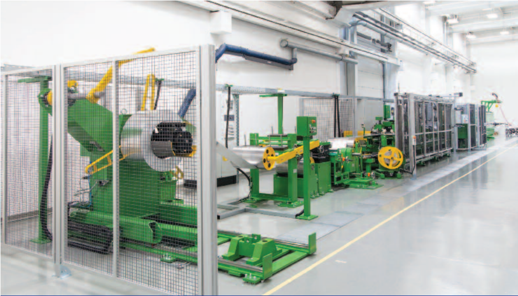
Tek bir kaynaktan şekillendirme, kaynak ve ekstrüzyon gibi temel işlemler. Rosendahl Nextrom'un RH-W üretim hattı.
