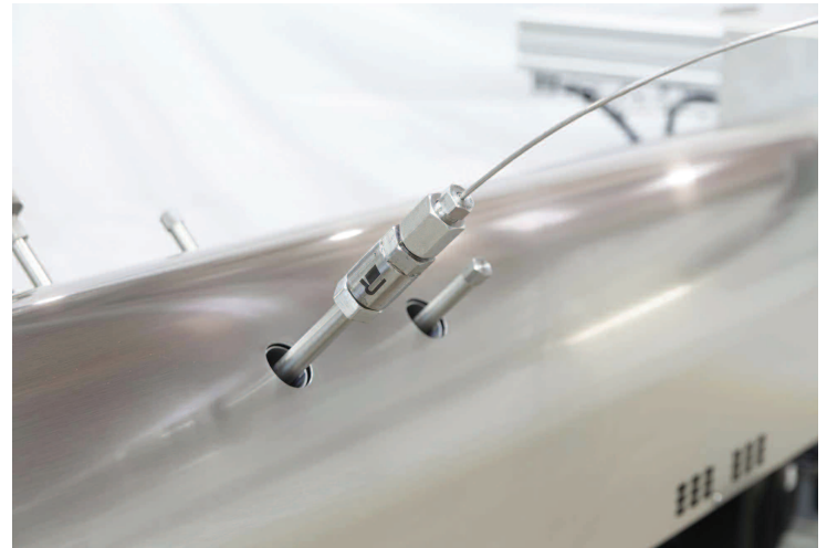
Rosendahl'ın Gaz Enjektör Valfi sayesinde sürekli ve yenilenebilir data kablosu üretimi
