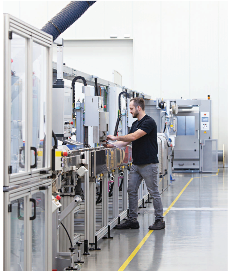
Pischelsdorf laboratuvarında yeni kurulan loose-tube üretim hattı
